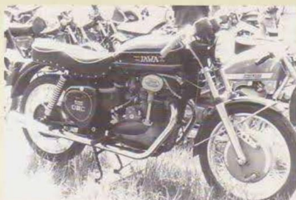
An dieser Maschine wurde der 500 cm 3 Motor einer Jawa 15/02 in ein englisches Fahrwerk von AJS/Matchless eingebaut, eine gelungene Kombination, wie man gut erkennt
