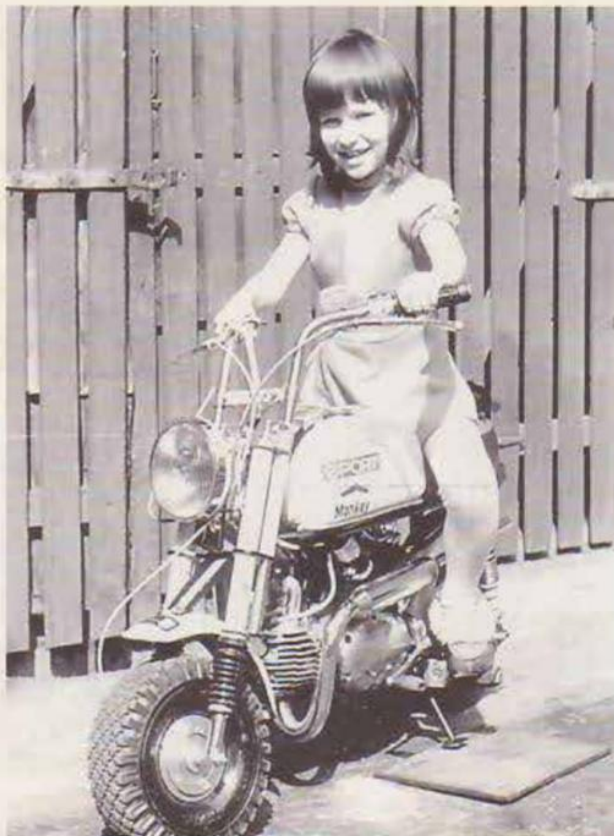
An diesem Eigenbau wurde der 50 cm 3 Motor eines Jawa Pionyr verwendet, auch Gabel und Federbeine kamen zum Einsatz, das Produkt ist unterdessen schon 40 Jahre alt
