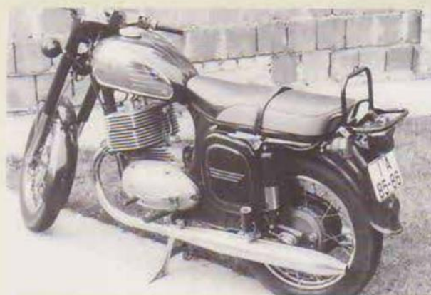
Auffällig an dieser Dreieinhalb ist die Zylinderpartie a la MZ/TS, der Berliner Roland Dummer, seines Zeichens perfekter Werkzeugmacher entwickelte die Zylindereinheit selbst
