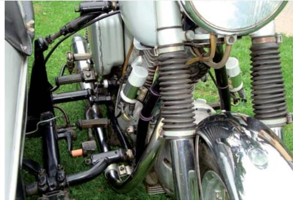
Technik pur, die Verbindung zwischen Maschine und Boot, die Faltenbälge verändern das „Gesicht“ der Gabel erheblich
