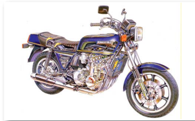
Das Original, die Kawasaki Z 1300 in ihrer Urform, wie sie in Deutschland auf den Markt kam – in Teilschnittdarstellung
