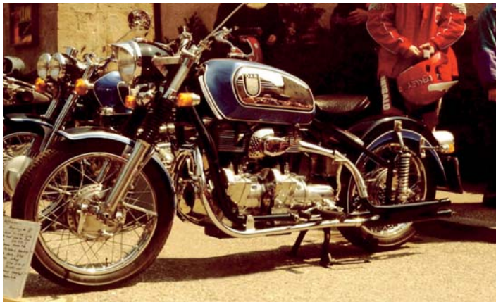
Die OAR 650 in der linken Seitenansicht, typisch sind die beiden Motoreinheiten aus der BMW-Einzylienderserie zu erkennen – „Altgediente DDR-Bürger“ tippten sogar auf Produkte der AWO aus Suhl, die Verwandtschaft ist ja gegeben
