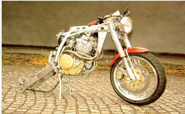
Nachdem das Hinterrad sowie das Federbein entnommen wurden, ist die Maschine schon stark „entblößt“ und viele Details sind gut zu erkennen; die Schwinge bleibt am Rahmen und wird senkrecht nach oben geklappt
