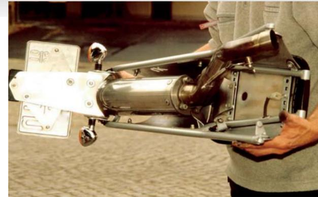
Der Meister hält das Heckteil bestehend aus Hilfsrahmen, Sitzbank, Schalldämpfer, Kennzeichenhalter und Elementen der Heckelektrik in den Händen
