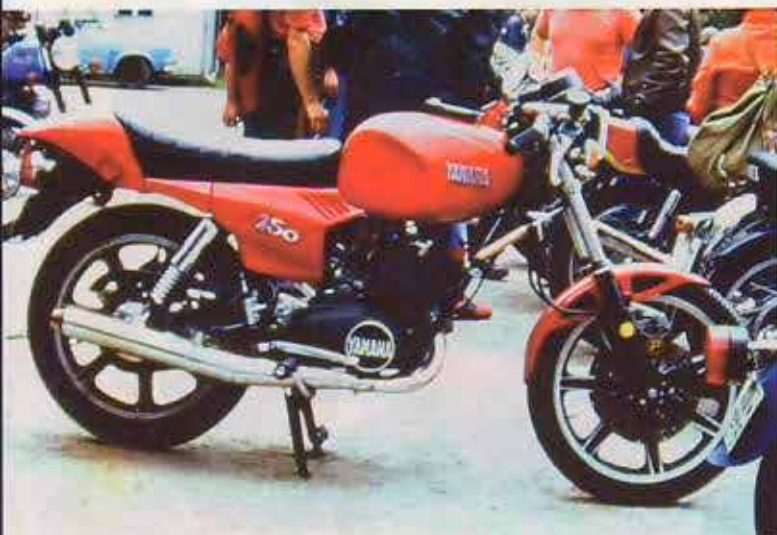
Ferenc Wayand versteckte unter der Bezeichnung Yamaha eine Pannonia P21, an welcher sogar die Gussräder auf Eigenbaubasis entstanden
