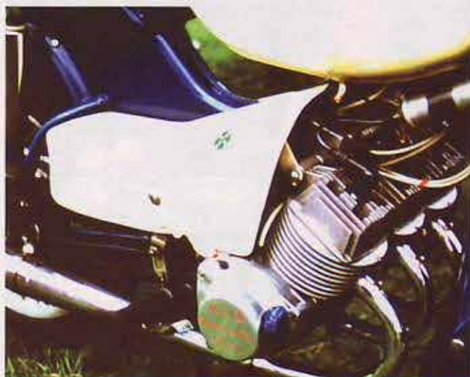
Ein Edelschrauber der Extragüte war der Weinböhlaer Schumann; auf Basis von Simson-Mopedmotorteilen fertigte er Eigenbauten mit Reihenmotoren von 2- bis 6-Zylindern, hier ein Erstlingswerk als 3-Zylinder Sperber
