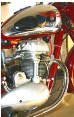
Eine frühe 15/01 mit der „Spirale“ zum Nockenwellenantrieb
