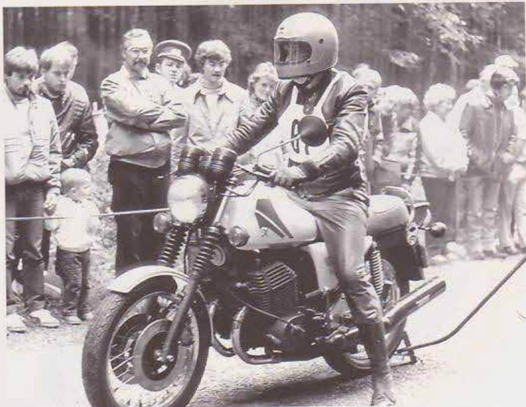
Rainer Richter gab die Maschine an seinen Exrennfahrerkollegen Eberhard Hellwig weiter, der sie dann am Vorderrad mit einer Doppelscheibenbremse von Brembo ausrüstete
