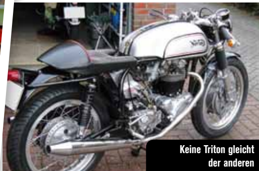
Selten findet man den AJS Spring-Twin-Motor als Paarung im Nortonrahmen
