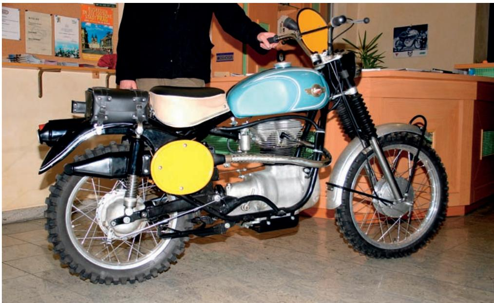
Dieses Top-Fahrzeug befindet sich im Besitz von René Nawrath, die Werksmaschinen waren ab 1959 mit dem zusätzlichen Dämpfer an der Telegabel ausgerüstet, ab 1959 wurde vorn das 21"-Rad verwendet und auch der kleine Scheinwerfer
