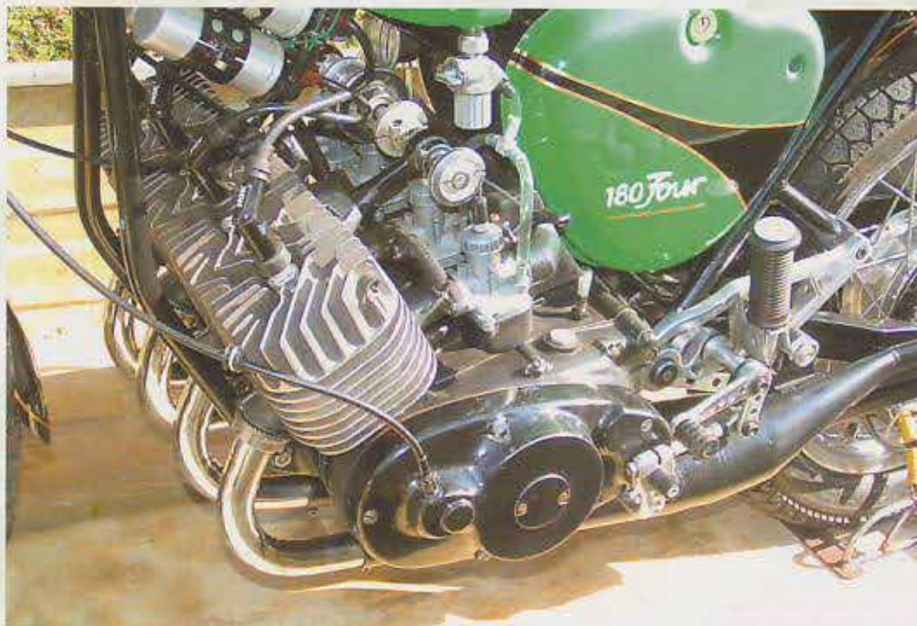
Seriesreife konnte allen Schumann-Experimenten bescheinigt werden, hier ein Vierzylindermotor im umgebauten Simsonfahrgestell, gut zu erkennen ist die Betätigungswelle für die Vergaserbatterie
