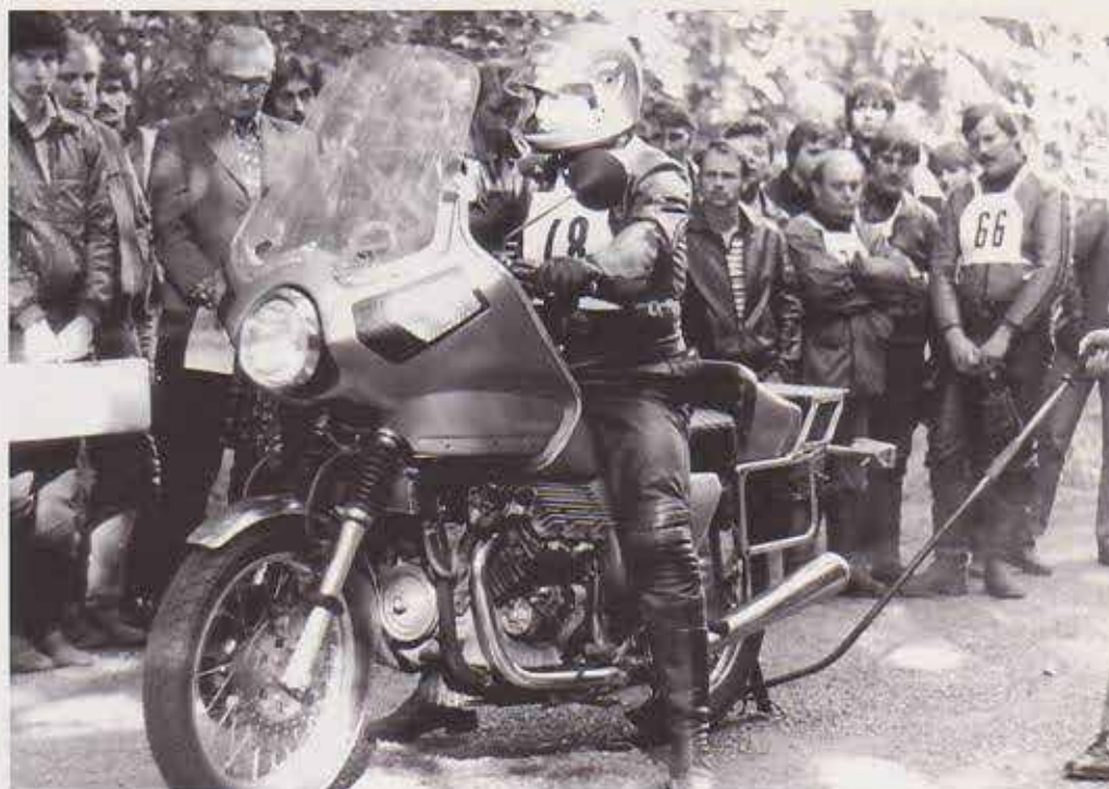
Karlheinz Engelke am Start des „Exotentreffens“ auf der Lückendorfer Rennstrecke. Die Maschine hat unterdessen die 3. Aufbaustufe hinter sich gebracht. Die große „Windjammerverkleidung“ macht sie zum schweren Tourer, auf jeder Seite befindet sich nur noch ein Schalldämpfer
