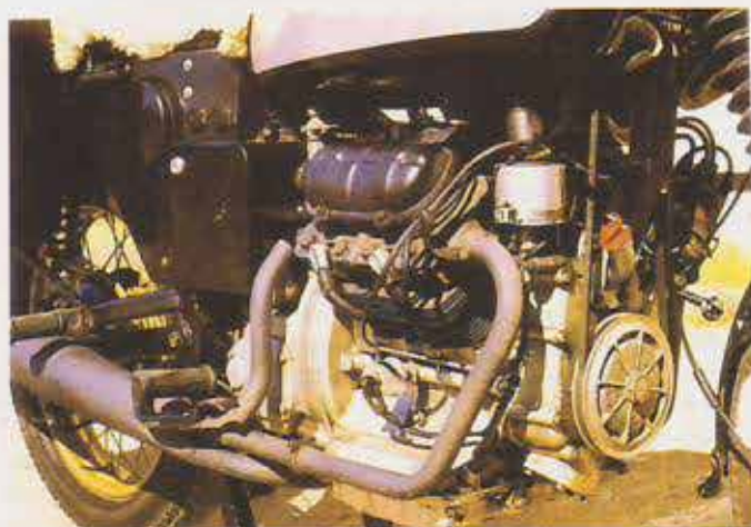
Details des typischen Automotors sind gut zu erkennen, Öldruckschalter, Zentriüge, der Lichtmaschinenantrieb und auch das Sammelstück der vier Auspuffrohre vor dem MZ Schalldämpfer
