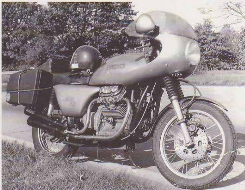
In der 2. Aufbaustufe zieren noch die vier Auspuffrohre die Maschine, die Lackierung ist unterdessen verändert und im Vorderrad verzögert eine Doppelscheibenbremse von Hartmut Bischoff
