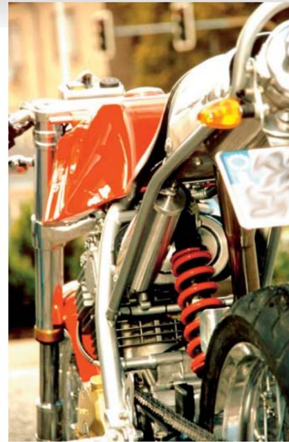
Der Blick von links hinten zeigt u.a.m. Teile des Hilfsrahmens für das Heck, das stehende Federbein von Paoli, links daneben die Werkzeugpatrone am Hilfsrahmen befestigt und davor das Gehäuse vom Luftfilter
