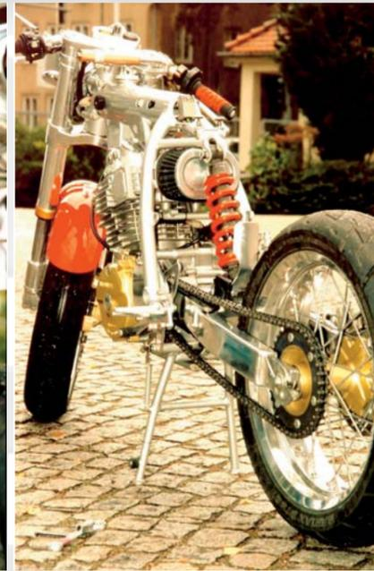
Tank und Heckteil sind abgenommen, noch steht die Maschine auf den Rädern und dem Dreifuß
