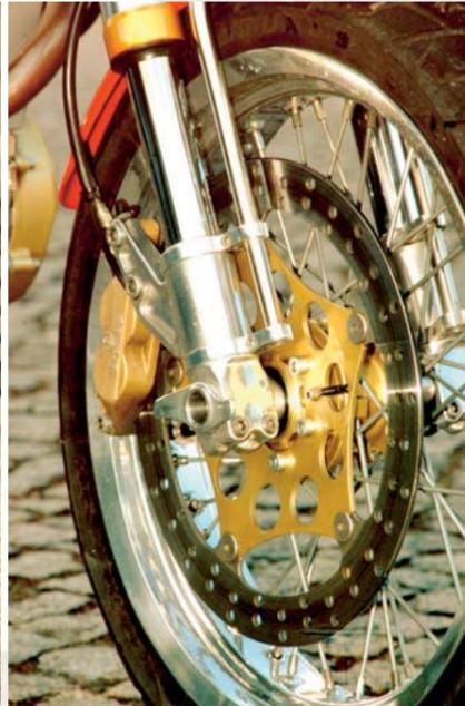
Prachtvoll gelungen ist die filigrane technische Ausführung am Vorderrad mit den Gleitrohren der Gabel, der Kotflügelstrebe, der Bremsanlage mit Scheibe und Sattel
