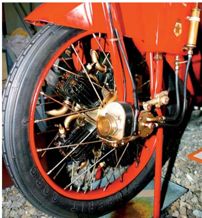
Motor details, der Öltank mit Handpumpe und die Ölpumpe sowie der Zündmagnet sind gut zu erkennen
