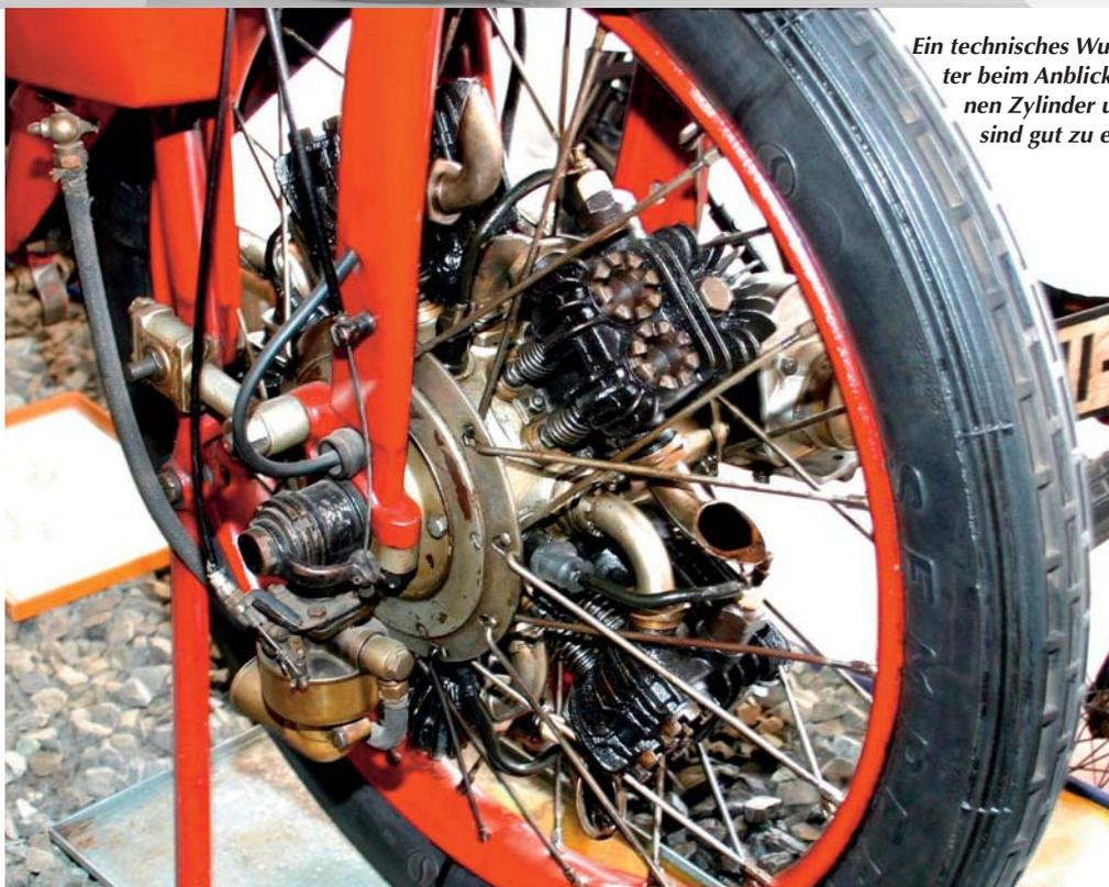
Ein technisches Wunderwerk offenbart sich dem Betrachter beim Anblick des Motors, der Vergaser, die einzelnen Zylinder und auch die Führung der Zündkabel sind gut zu erkennen
