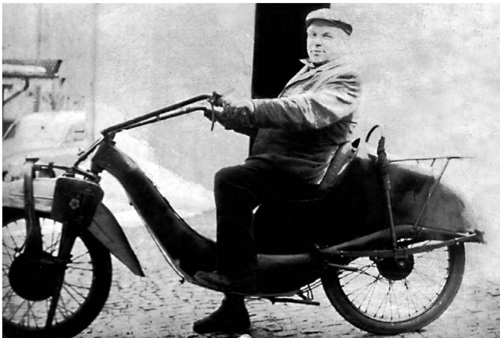
*Ein sehr frühes Foto vom Meister Fritz Olbrich auf der Megola Serienausführung, welche er auch im Besitz hatte. Der aufmerksame Betrachter wird den Motor suchen. Da dieser z. Z. der Aufnahme instandgesetzt wurde, ist ein „Notrad“ montiert, ebenso ist am Hinterrad der Antrieb zur Lichtmaschine nicht montiert, aber die Hinterradfederung ist gut zu erkennen*
