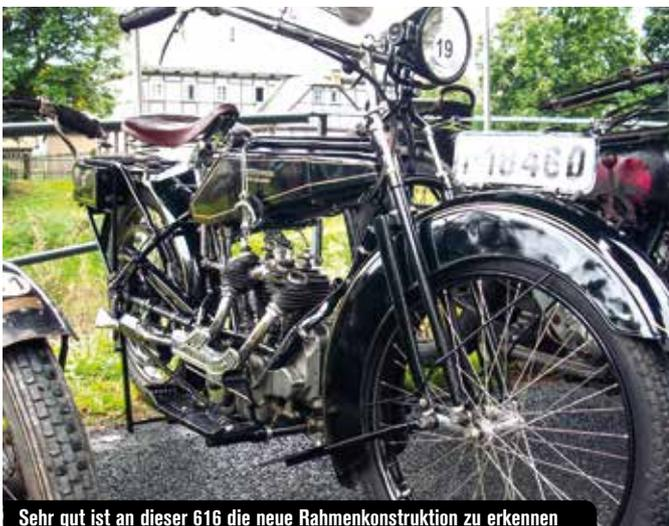
Sehr gut ist an dieser 616 die neue Rahmenkonstruktion zu erkennen
